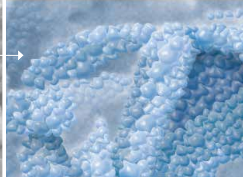
Calciumfluorid-ähnliche Partikel dicht an dicht nach der Applikation von Fluor Protector S, rasterelektronenmikroskopische Aufnahmen, Vergrößerung: 30'000 x (Ivoclar Vivadent, F&E 2012)
